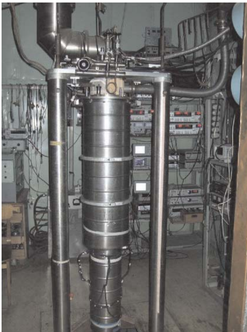
Рис. 7: Внешний вид криостата ядерного размагничивания
