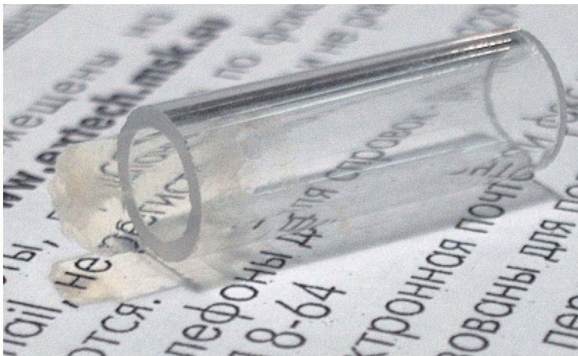
Рис. 2: Внешний вид аэрогеля (выступает из кварцевой трубки)
